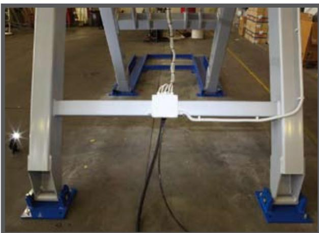
Ces photos montrent que le circuit électrique est parfaitement intégré à la machine, tout en étant facilement accessible pour le technicien chargé de la maintenance.
