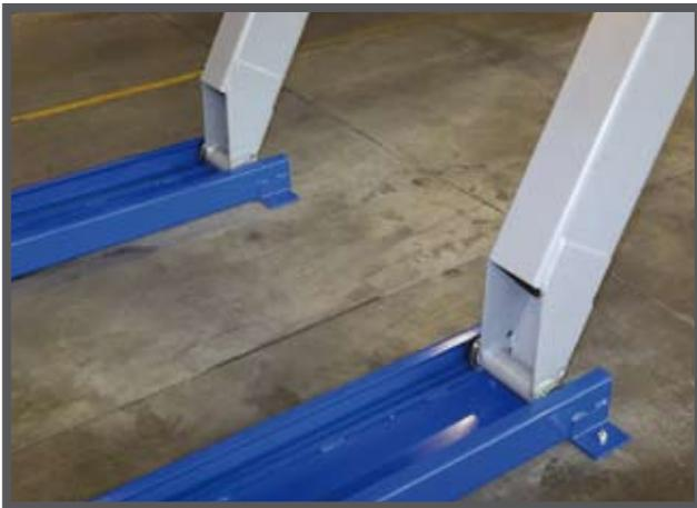
Le chemin de roulement du ciseaux du Rex PF sont fixées au sol à l'aide de chevilles mécaniques. Les galets auto lubrifiés permettent d'éviter leur détérioration et prolongent la durée de vie du matériel. Le châssis est fixé au sol par des chevilles mécanique en comprenant des douilles en plastique anti usure
