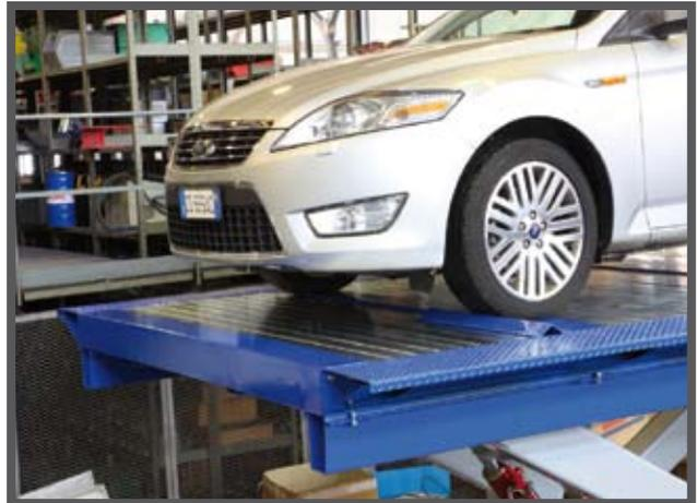
La photo détaillée met en évidence la cale située sur la plateforme (de série) et qui est destinée au positionnement correct de la voiture côté avant.
