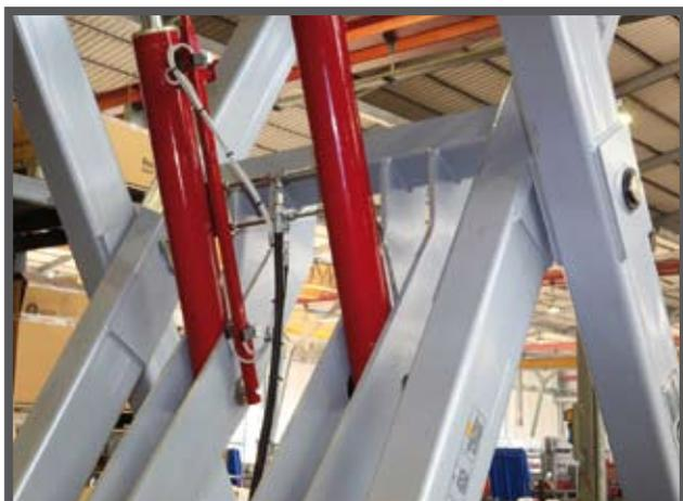
Le système hydraulique est composé de deux vérins (fabriqués par Omer S.p.A.) chacun doté d'un équilibreur de pression permettant l'adaptation aux fortes variations de la pression d'huile.
