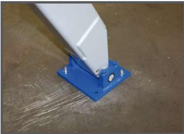
La partie fixe est également dotée d'une base, fixée au sol par des chevilles mécaniques et montée à l'aide d'un pivot inséré sur des douilles en plastique anti-usure. Cette installation améliore évidemment la durée de vie du produit.
