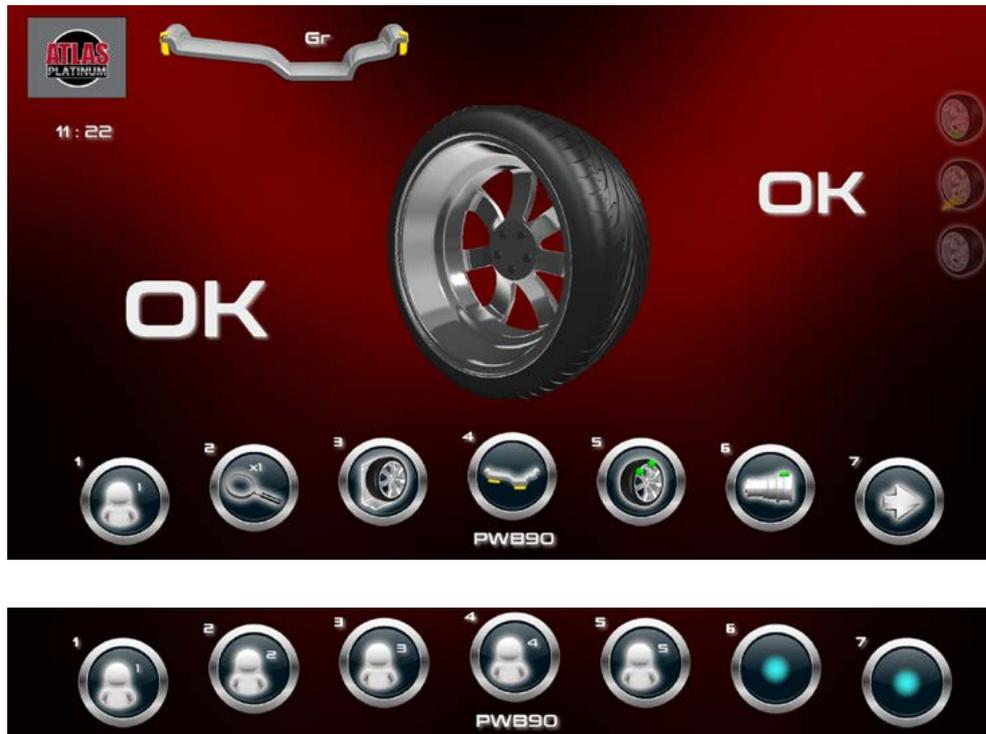
L'équilibreuse peut être utilisée en même temps par 5 utilisateurs différents qui, par l'intermédiaire d'une simple séquence, peuvent mémoriser leur condition de travail et la rappeler en cas de nécessité.
