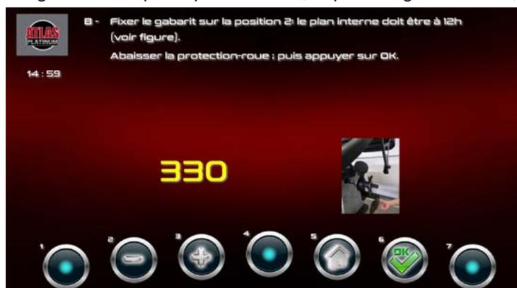
Mesurer la distance entre la ligne de référence sur la protection du sonar et le plan du gabarit d'étalonnage opposé au sonar
