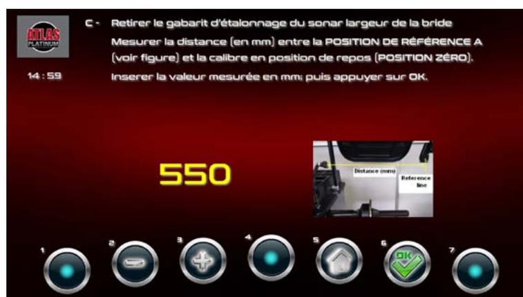
Mesurer la distance en mm entre la ligne de référence sur le sonar et la pince de mesure de distance en position de repos
