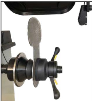
Installer sur l'arbre fileté les deux cônes de plus grande taille fournis avec l'équilibreuse.
