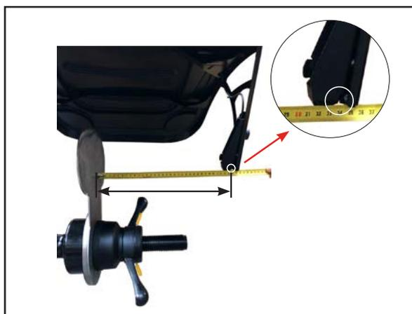
Retirer les deux cônes de l'arbre. Fixer fermement le dispositif d'étalonnage à l'arbre de l'équilibreuse à l'aide du contre-écrou.
