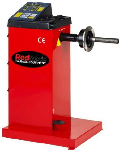
Le Redback 109 est un équilibreur de roue manuel à entrée manuelle capable d'équilibrer des roues jusqu'à 24 ". Ce modèle dispose de modes d'équilibrage statique, acier et ALU et d'une pédale de frein assurant un positionnement précis du poids de la roue.
