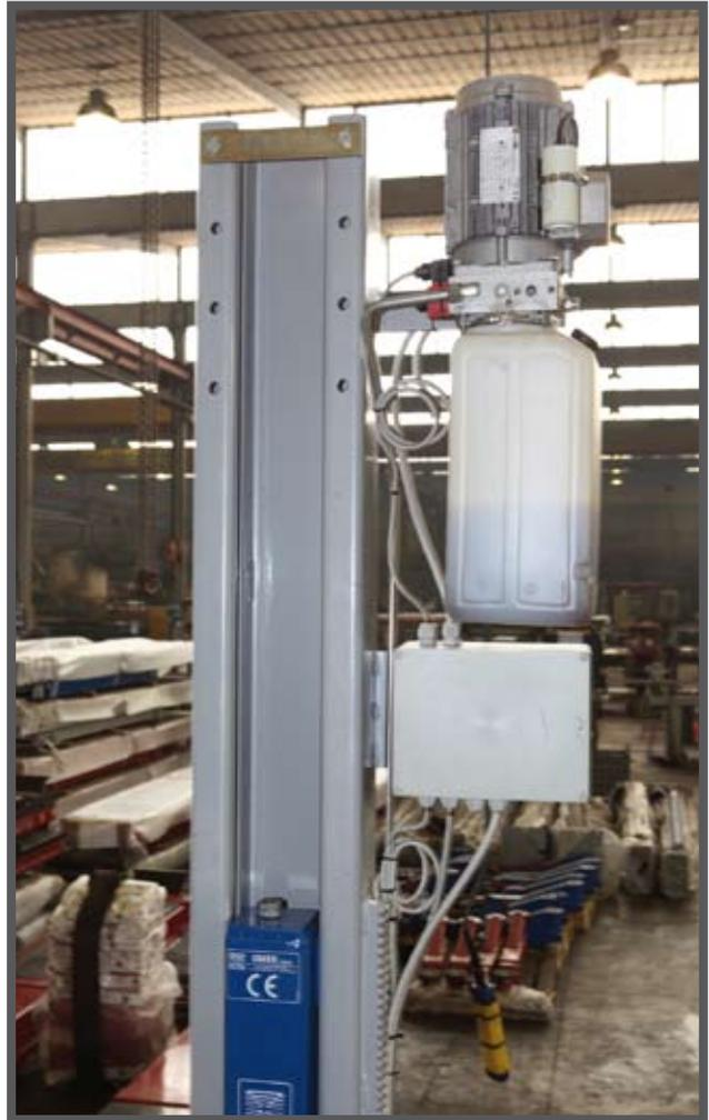
Le format compact du groupe électro-hydraulique et du tableau électrique, placés à l'extrémité supérieure de la colonne latérale gauche, offre une efficacité maximale et un encombrement minimal. Le stationnement des voitures se déroulant sans obstacle particulier.
