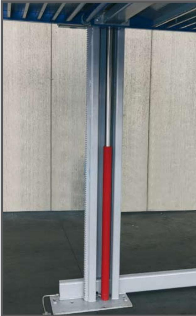
Le vérin cylindre hydraulique de levage à deux rangées (RAM, fabriqué par O.M.E.R S.pA) permet un levage direct, sans nécessiter d'équipements auxiliaires, que ce soient des câbles ou des chaînes.
