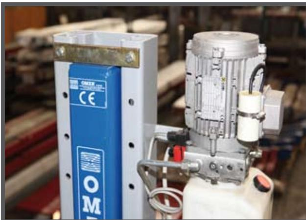
Le bloc vertical relatif à la course de la plateforme, placé à l'extrémité de la colonne, est conçu pour assurer la sécurité de la plateforme et déterminer la hauteur maximale de la course, en fonction des besoins du client.
