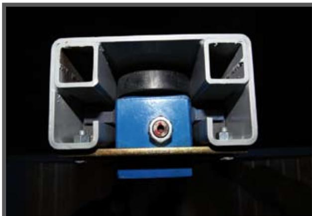
La photo détaillée ci-dessus montre le bogie de la plateforme. Le bogie est guidé à l'aide de roues et de patins en Nylon associés à du bisulfure de molybdène.
