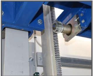
La photo du dessous du système montre la colonne et le vérin (fabriqué par O.ME.R. S.p.A.), la crémaillère et la barre de torsion, la chaînette de protection des câbles d'alimentation à bord de la plateforme et le boîtier de dérivation électrique.
