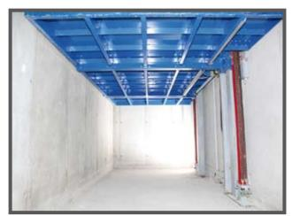
La machine est équipée d'un système de barre de torsion qui roule sur les deux crémaillères fixées sur les côtés des deux colonnes.
