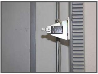
La photo ci-dessus montre l'un des interrupteurs de fin de course positionné sur la machine.
