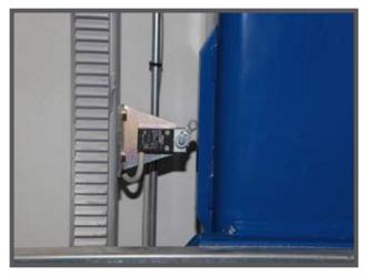
Dans cette photo détaillée, le fonctionnement du fin de course de ralentissement et de régulation de la course, est mis en évidence par la longueur de la came d'actionnement (plus longue que la came d'arrêt).
