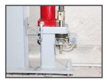
Un système de fin de course est placé au niveau de la base du piston en vue de contrôler la tension des chaînes de levage (deux par piston) afin de permettre le blocage de la plateforme en cas de dysfonctionnement ou de rupture d'au moins une chaîne.
