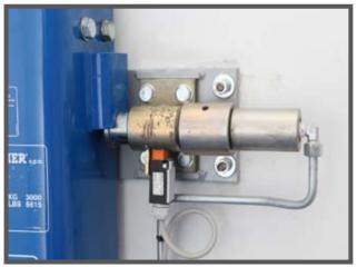
Ensuite, la butée redescend pour pouvoir s'accrocher sur le piston, repoussé à présent de son axe, ce qui offre une stabilité totale. À ce stade, le système hydraulique de levage des deux pistons est relâché, évitant ainsi les tensions continues et ultérieures dues à la pression constante sur le circuit hydraulique.
