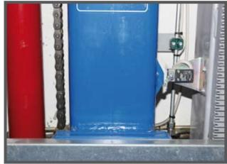
Cette photo, en revanche, montre le fonctionnement du fin de course d'arrêt, positionné sur la colonne opposée au fin de course de ralentissement, et identifiable par une came d'actionnement plus petite.
