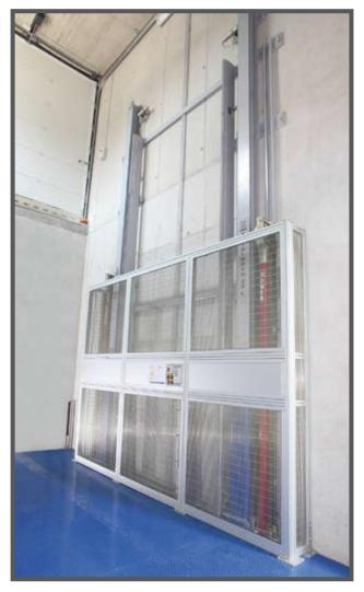
La plateforme est dotée d'une protection d'une hauteur de 2,50 mètres non amovible autrement qu'avec les outils particuliers des techniciens de maintenance. Cette protection empêche tout contact avec les composants de mouvement de la plateforme (norme 2006/42/EC).
