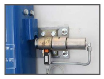
La butée de la plateforme dépasse le point de positionnement du piston du bloc mécanique du niveau, ce qui permet sa sortie.
