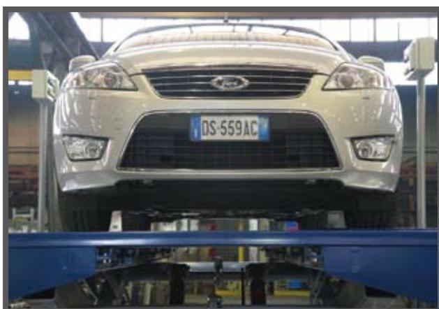
Une des caractéristiques essentielles des produits Omer SPA est d'offrir un équilibrage parfait du poids sur la plateforme, indépendamment de la façon dont le véhicule y est garé. Le système des machines Omer SPA, et tout particulièrement le TOTAL REX, permet le levage de la plateforme de manière parfaitement parallèle au sol, sans aucune torsion ou pliage.
