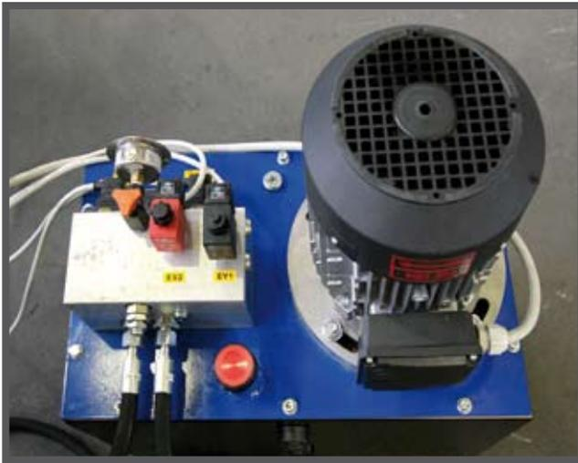
La vue globale sur la centrale électro-hydraulique souligne son format compact et met en évidence le peu d'espace que nécessite l'installation complète du groupe de commande.
