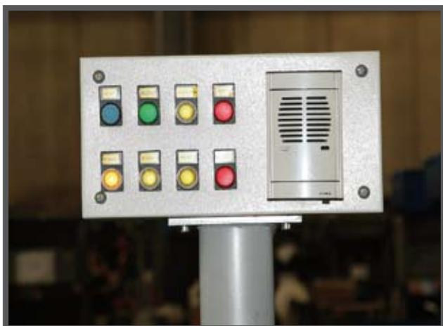
En complément des commandes de base qui permettent de rejoindre le niveau souhaité, le tableau de commande est doté de boutons d'urgence et d'un interphone utilisé pour communiquer, via un cadran d'appel téléphonique, avec l'extérieur.
