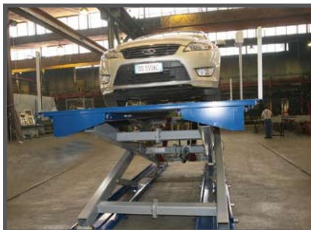
Les composants qui assurent en partie une sécurité infaillible au véhicule, une fois à bord, sont les systèmes de cale roue, fixés sur la plateforme. Ces systèmes empêchent l'oscillation du véhicule vers l'avant et vers l'arrière, une fois qu'il est placé sur la plateforme.
