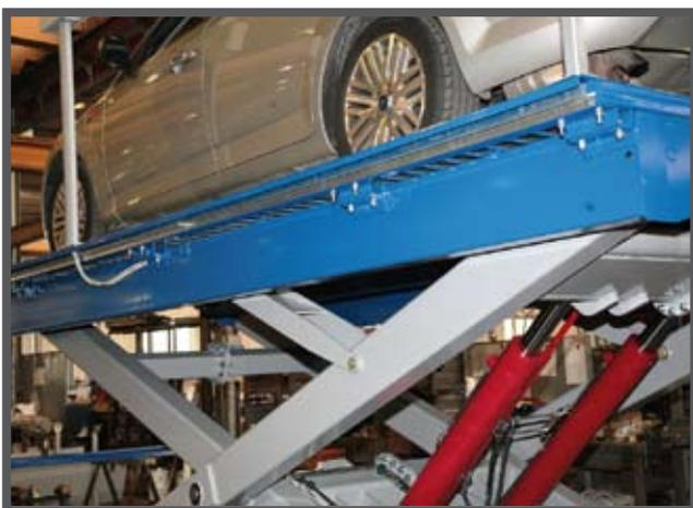
Les différents raccordements électriques du tableau de commande au tableau électrique de fonctionnement sont rigoureusement protégés dans des caniveaux en aluminium spécialement conçus à cet effet et qui permettent d'éviter leur détérioration et leur endommagement. Ce détail révèle le soin apporté au produit.
