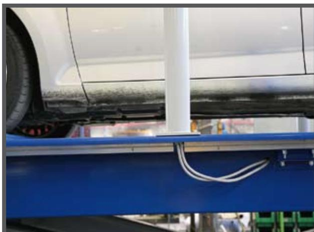
Photo détaillée supplémentaire du raccordement électrique avec le tableau de commande. L'image montre le caniveau en aluminium destiné au passage du raccordement.
