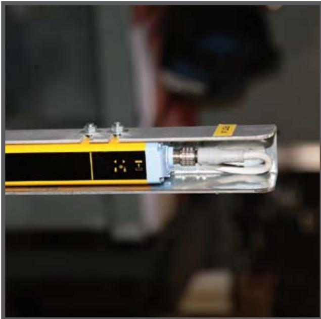
La photo détaillée montre la photocellule encastrée dans une structure en fer galvanisé qui sert de protection, que ce soit pour le dispositif émetteur (ou récepteur) ou pour les connecteurs électriques.
