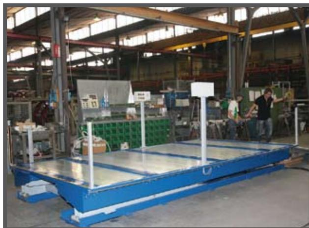
La gamme des plateformes à ciseaux s'agrandit avec l'arrivée de solutions qui permettent la présence d'une personne à bord du véhicule. Ces solutions sont réalisables lorsque la avec une course limitée à 4 mt. distance à parcourir est inférieure à 4 mètres, ou, toujours pour la même course, lorsqu'il n'existe aucun moyen de fixer la machine aux murs. Cette technologie en effet, est autoporteuse.
