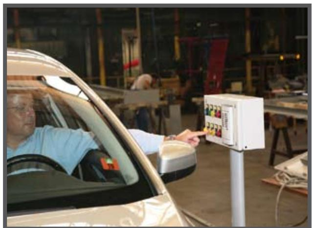
Le positionnement du tableau de commande a été spécialement étudié afin qu'à l'arrêt du véhicule, le conducteur puisse contrôler aisément l'ascenseur en toute simplicité, à travers la fenêtre et ce, confortablement assis au poste de conduite.
