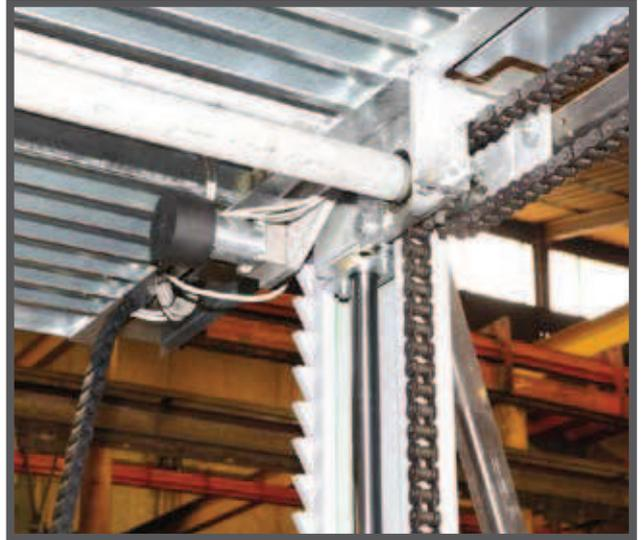
La photo détaillée montre qu'il s'agit d'un système de doubles chaînes, positionné sur chaque angle de la machine, qui enroule de manière complète le pignon denté des barres de torsion. Le maintien des chaînes sous tension rend l'inclinaison du système impossible.
